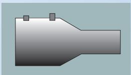
Schlauchanschluss Kessel, reduziert Ø 50 / Ø 35
